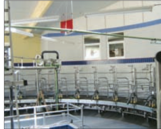
Das Melkkarussell AutoRotor Magnum 40 von WestfaliaSurge hat 32 Plätze und bietet gute Arbeitsbedingungen für Melkerinnen und Melker.
