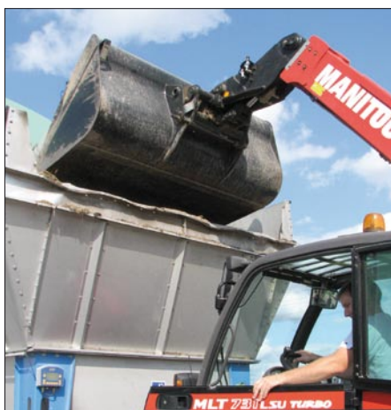
Uwe Kirsten beim Befüllen des Annahmedosierers der Biogasanlage.
